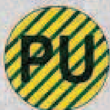
1160 00 80 conduttore di protezione non collegato a terra
