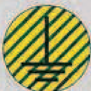
1160 00 10 messa a terra
