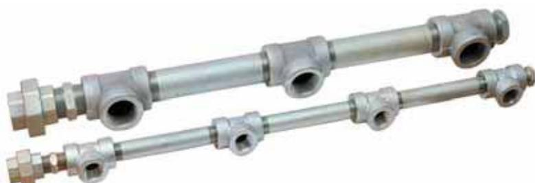
**Collettori per impianti CO<sub>2</sub>:** realizzati con tubazione SCH 80 e raccorderia ASA 3000, disponibili da 3/4" a 2".
