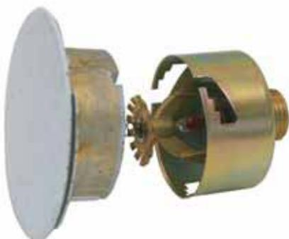
Sprinkler modello CONCEALED da incasso con bulbo da 5 mm, fattore K 80, filettatura di attacco da 1/2" e orifizio da 15 mm.
