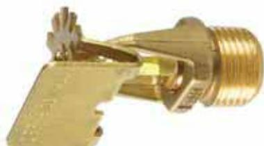
Sprinkler modello SIDEWALL con bulbo da 5 mm, fattore K 80, filettatura di attacco da 1/2" e orifizio da 15 mm.
