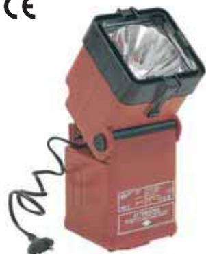
Faro portatile con batterie ricaricabili, dotato di due lampade una allo XENON e una piccola ad incandescenza. Alimentazione di rete a 220 V. Tempo di ricarica 24 ore per un'autonomia di 120 minuti.
