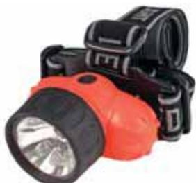
Lampada da testa dotata di 6 led ultra luminosi e una lampadina krypton. Pulsante con 4 scelte alternative: 1 led, 3 led o 6 led insieme, lampadina krypton. Basso consumo delle batterie. Durata oltre 80 ore a 3 led. Batterie: 3 x AAA
