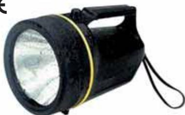
Lanterna galleggiante antiurto dotata di cinturino di sicurezza per trasporto. Dimensioni contenute: Ø 72 x 120 mm. Funziona con 4 batterie formato D che alimentano una lampada alogena da 4,8V - 0,7A.
