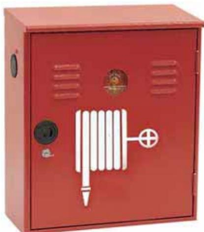
**Caratteristiche costruttive:** realizzata in lamiera zincata da 7/10 mm, verniciata a base di resina poliesteri rossa RAL 3000 a norma ISO 9227 con elevata resistenza agli agenti atmosferici. La cassetta è dotata di portello con apertura a 180° con simbolo adesivo di identificazione, istruzioni di installazione, d'uso e manutenzione.
